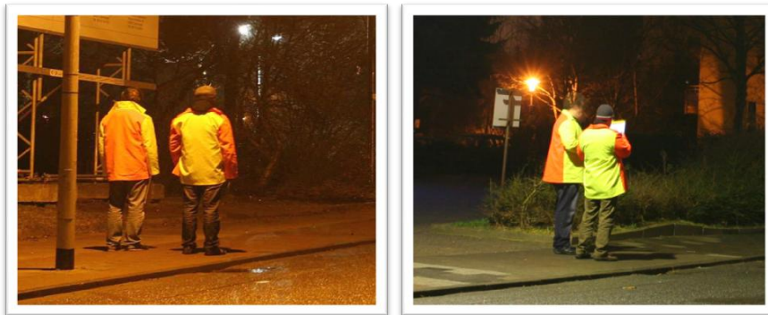
Abbildung 7: Auffälligkeit der Warnwesten unter dem gelben Licht der SON-H 68 W Lampen (linkes Bild) und dem weißen Licht der HME 125 W-Lampen (rechtes Bild)
