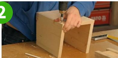
Die Seitenwände mit je zwei Schrauben an Boden und Rückwand befestigen.
