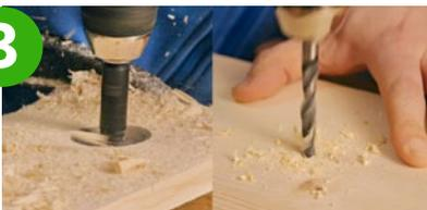
Einflugloch (45 mm) in ca. 21 cm Höhe bohren und darunter ein weiteres Loch für die Sitzstange (8 mm) mittig in die Vorderseite.
