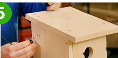
Dach aufsetzen und mit sechs Schrauben an Rück- und Seitenwänden befestigen. Zwei Ringschrauben in die Seitenwände drehen und den Draht zum Aufhängen daran befestigen.
