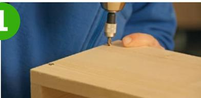
Bauteile ausmessen und zurechtsägen (Maße s. u.). Zwei Löcher in die Bodenplatte bohren, damit später Feuchtigkeit abfließen kann. Rückwand anschrauben.
