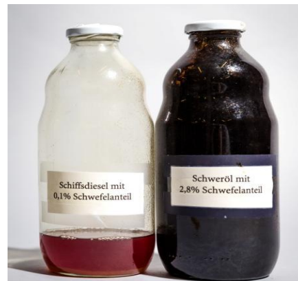
Schiffsdiesel mit 0,1% Schwefelanteil neben dem pechschwarzen Schweröl mit 2,8%
