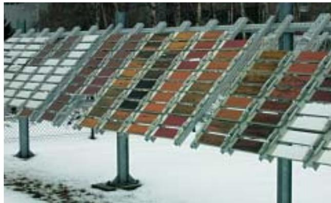
**Freilandversuch:** Acht Monate mussten die lasierten Kiefernholzer in unserem Test Regen, Sonne, Frost und Schnee trotzen. Die 45-Grad-Neigung entspricht in etwa einer doppelt so langen Bewitterung senkrechter Hausfassaden.
