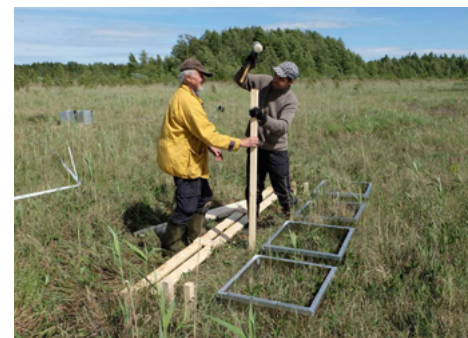
Installation von Treibhausgas-Messkammern im Projekt LIFE Peat Restore.
