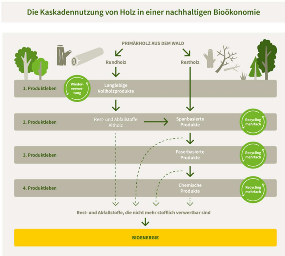
Abb.2: Schematische Darstellung des Prinzips der Kaskadennutzung von Holz in einer nachhaltigen Bioökonomie (NABU eigene Darstellung / Grafik: Pia Wieland)
