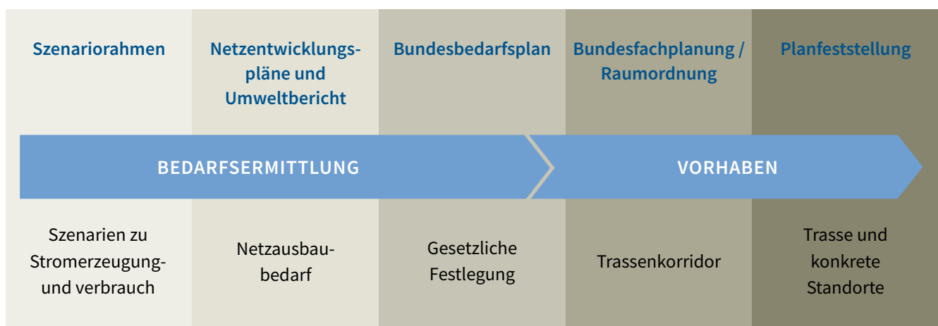
Abb. 1: Die Planung von länder- und grenzübergreifenden Höchstspannungsleitungen erfolgt nach EnWG und NABEG in einem fünfstufigen Verfahren mit Öffentlichkeitsbeteiligung.
